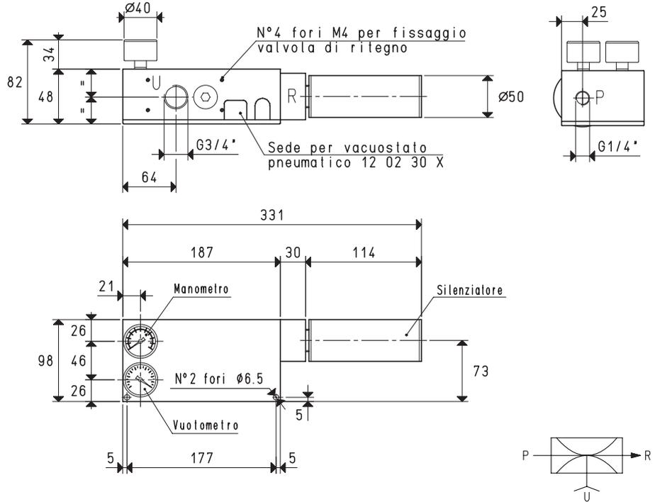
P=CONNESSIONE ARIA COMPRESSA    R=SCARICO    U=CONNESSIONE VUOTO
